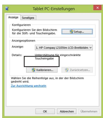
Wenn ein Treiber benötigt wird, muss der Touch über diesen Treiber kalibriert werden. Ist es ein HID Touch, muss die Windows Kalibrierung in der Systemsteuerung durchgeführt werden.
